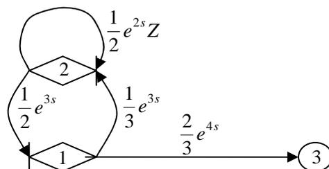
图 8 顶部回路执行 2 次的条件下网络的实现情况
